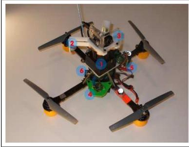
(a) Laser-equipped Quadrotor helicopter
